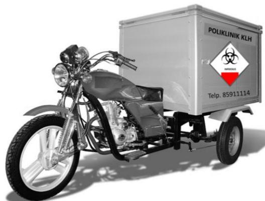
Gambar 9. Contoh pemberian simbol pada mobil roda 3 (tiga) untuk mengangkut limbah infeksius oleh penghasil limbah medis dari fasilitas pelayanan kesehatan.
