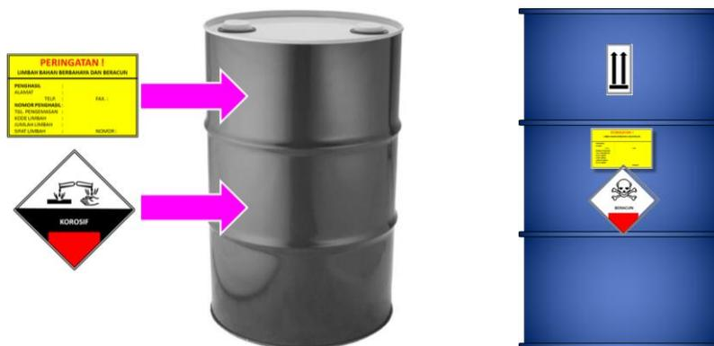
Gambar 7. Contoh pemberian simbol dan label pada wadah/kemasan drum
